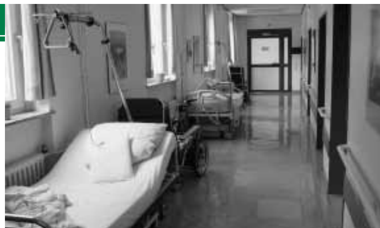
Betten im Flur verstellen Rettungswege.
